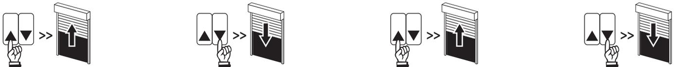
⚠ - **Empfehlung: Fahren Sie den Rollladen direkt nach dem Einbau des Motors zweimal auf und ab!**
